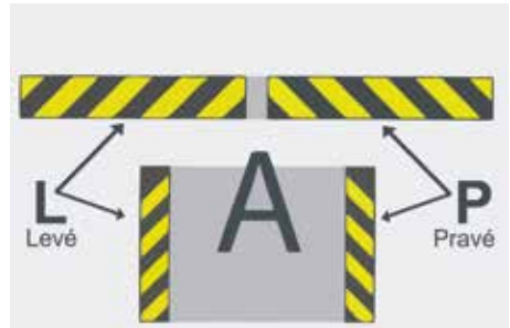
Správné umístění výstražných pásů.
